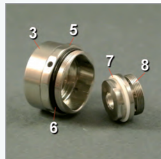
Die UC upper section [8] , die UC middle section [5] und die UC bottom section [3] sind nun komplett und werden zusammengeführt.
