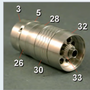
In dieser Ansicht kann man gut sehen wie die Counter nut [33] oben festgeschraubt ist.
