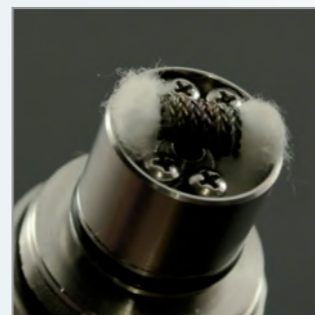
Extremwicklung - Zipper-Coil / 0.24 Kanthal, verdreht & parallel (linksrum/rechtsrum) / 6 Windungen / Ø2.5 mm / Bio-Watte / ca. 0,6 Ω
