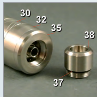
Nachdem der Lower part of the topcap [35] auf dem Upper tank segment [32] festgeschraubt wurde fehlt noch die Top nut [38] mit dem O-Ring (10x1) [37] und dem Drip-Tip Anschluss. In der Top nut [38] befindet sich noch ein weiterer O-Ring (5x1,5) [36] (nicht im Bild zu sehen).
