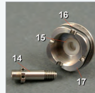
Von unten wird der O-Ring 11x1,5 [16] , der Center post insulator [15] und der Center post [14] durch das Atomizer deck [17] gesteckt.
