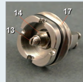
In den Center post [14] wird jetzt noch die Air regulation screw [13] hineingeschraubt. Die Baugruppe Body [B] ist nun fast komplett.
