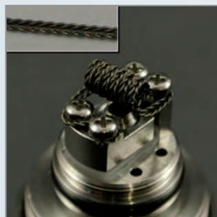
Extremwicklung - Zipper-Coil / 0.24 Kanthal, verdreht & parallel (linksrum/rechtsrum) / 6 Windungen / Ø2.5 mm / Bio-Watte / ca. 0,6 Ω
