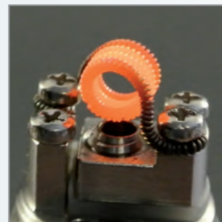
Extremwicklung - Clapton-Coil / 0.2 Kanthal um einen 0.3er Kanthal Kern gewickelt / 4 Windungen / Ø3.5 mm / ca. 1.0 Ω
