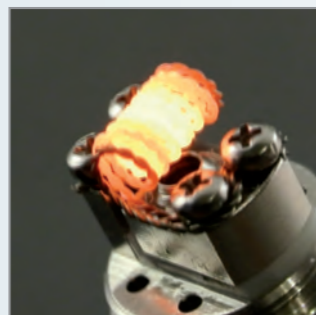
Extremwicklung - Zipper-Coil / 0.24 Kanthal, verdreht & parallel (linksrum/rechtsrum) / 6 Windungen / Ø2.5 mm / Bio-Watte / ca. 0,6 Ω
