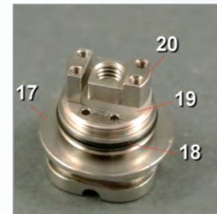
Auf das Atomizer deck [17] wird der O-Ring 10x1,5 [18] , der Atomizer deck insulator [19] und der Positive block [20] aufgesetzt.
