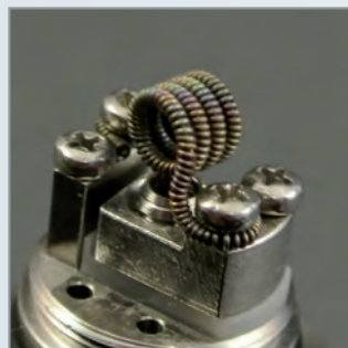
Extremwicklung - Clapton-Coil / 0.2 Kanthal um einen 0.3er Kanthal Kern gewickelt / 4 Windungen / Ø3.5 mm / ca. 1.0 Ω
