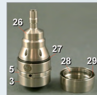
Nun wird das Lower tank segment [28] mit dem innenliegenden O-Ring (19x1,5) [29] aufgeschraubt.
