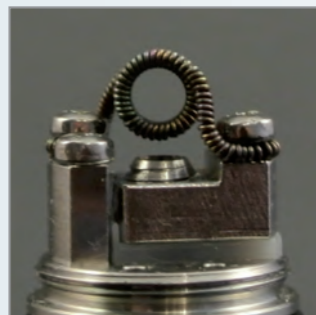
Extremwicklung - Clapton-Coil / 0.2 Kanthal um einen 0.3er Kanthal Kern gewickelt / 4 Windungen / Ø3.5 mm / ca. 1.0 Ω
