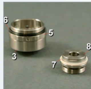
Auf die UC upper section [8] wird ein weiterer Seal ring (13x1) [7] gesteckt.
